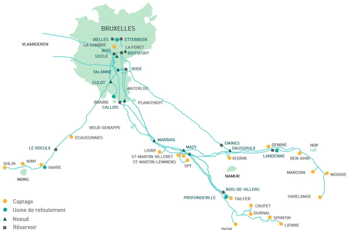
Figure 77: Activités de production, stockage et transport d'eau potable de VIVAQUA (source : VIVAQUA, 2020b)
